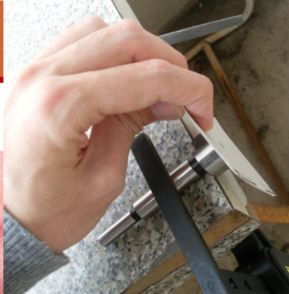
Astuce pour ne pas abîmer les lames en limant la pointe : utiliser un cache en carton !
